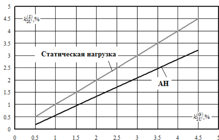
Рис. 10. Симметрирующий эффект асинхронной нагрузки
