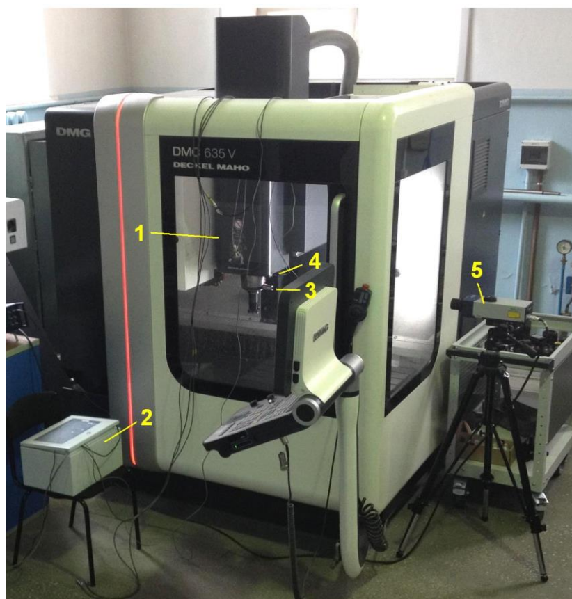
Рис. 9. Шпиндель обрабатывающего центра DMC 635 V (1) с виброизмерительным комплексом NI (2), датчиками вибрации AP85 (3) и CMCP 1100 (4) и лазерным виброметром (5)
