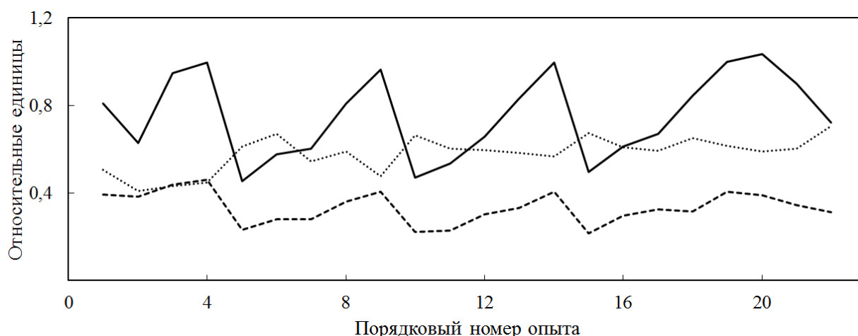
Рис. 1. Результаты измерений по опытам на пылесистеме 5А: — \Delta p/\Delta p_{\max} – полное сопротивление на участке вход в ШБМ – выход из сепаратора, отнесенное к максимальному сопротивлению на данном участке; ..... \mu – концентрации пыли на выходе из ШБМ; --- R_{90} – тонина помола пыли за сепаратором в относительных единицах
